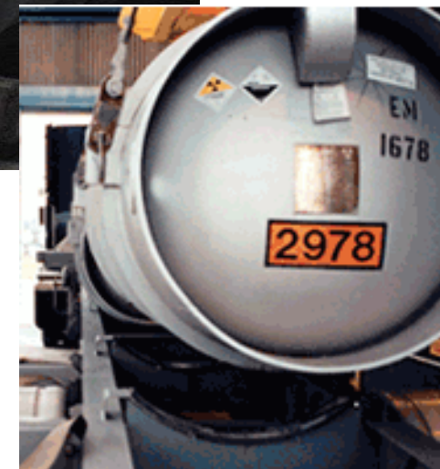
Маркированный цилиндр для природного UF_6 , США
