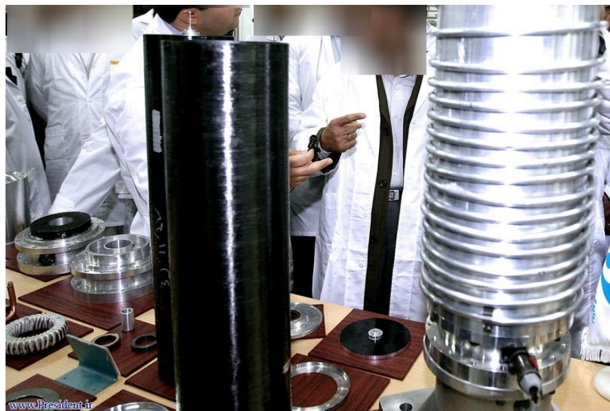
Части иранской газовой центрифуги
