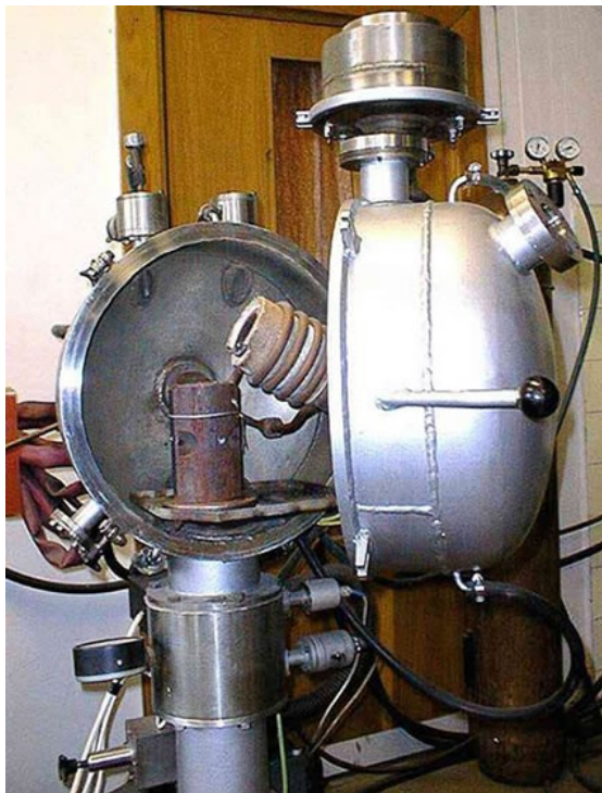
» Вакуумная индукционная печь
