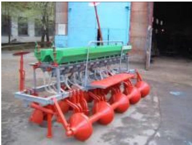
Гребневая сеялка СГНМ-2,8 конструкции КазНИИВХ
