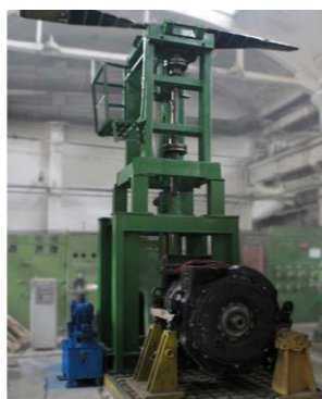
Испытательный стенд винта изменяемой геометрии
