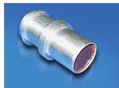
Конечная цель – капсула, заполненная спрессованным порошком \text{MoO}_3
